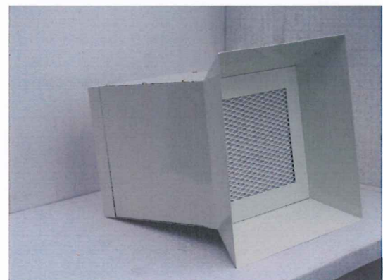
脱臭装置 アンモニア試験 500ppm 入口 ↓ 120ppm 出口
