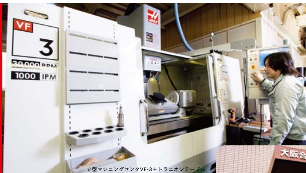
立型マシニングセンタVF-3+トラニオンテーブル
