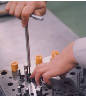
パンチ、ダイの交換がしやすい金型構造
