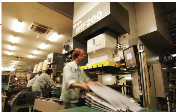
ACサーボプレス。従来のプレス部門でも応用力を高める。
