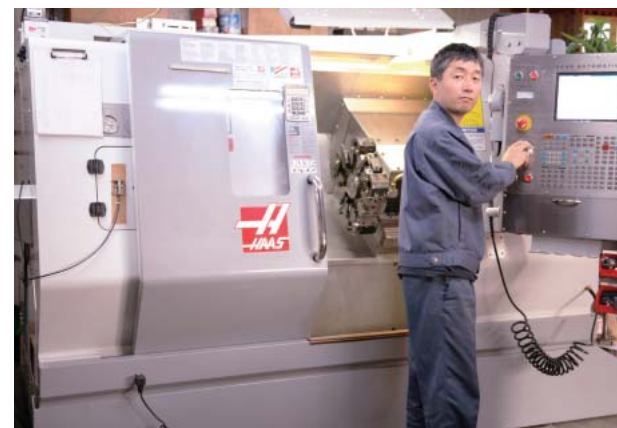
今年の3月に納入されてから、大活躍のCNC旋盤SL-20。262mm×508mm、主軸回転数4,000rpm。
