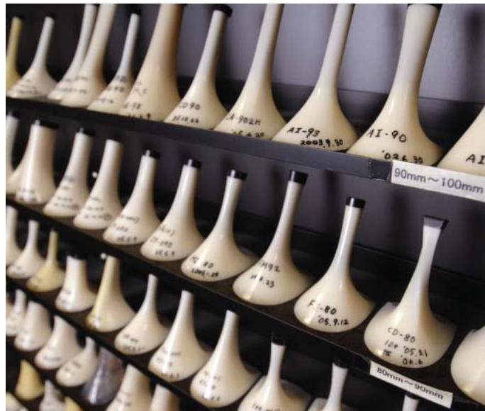
射出成型による靴のヒール部分のサンプルが並ぶ。
