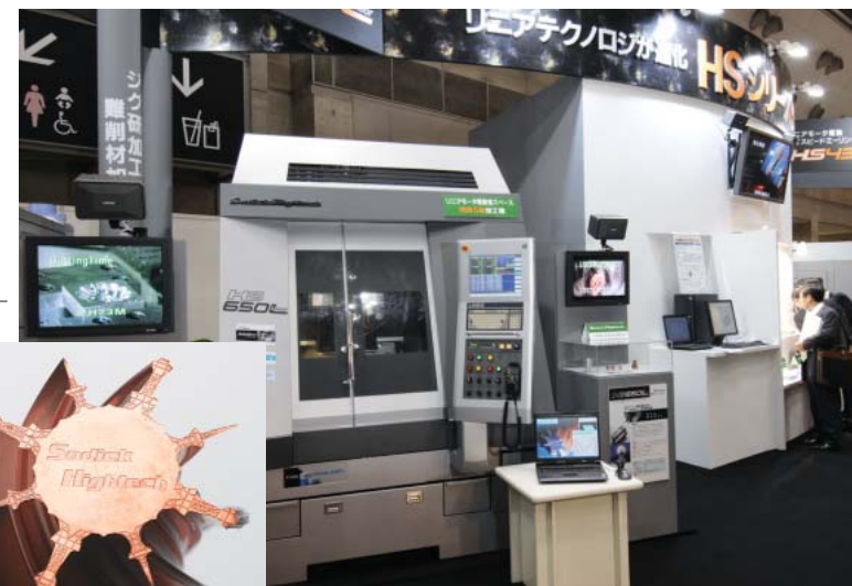
5軸加工機「HS650L」によるヘリカル電極の加工事例
