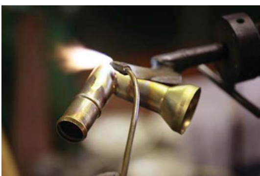
真鍮パイプ友ロー付け加工
