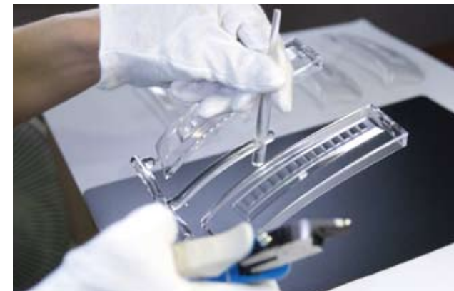
自動車のヘッドランプレンズ 目視検査による徹底した品質管理を行う
