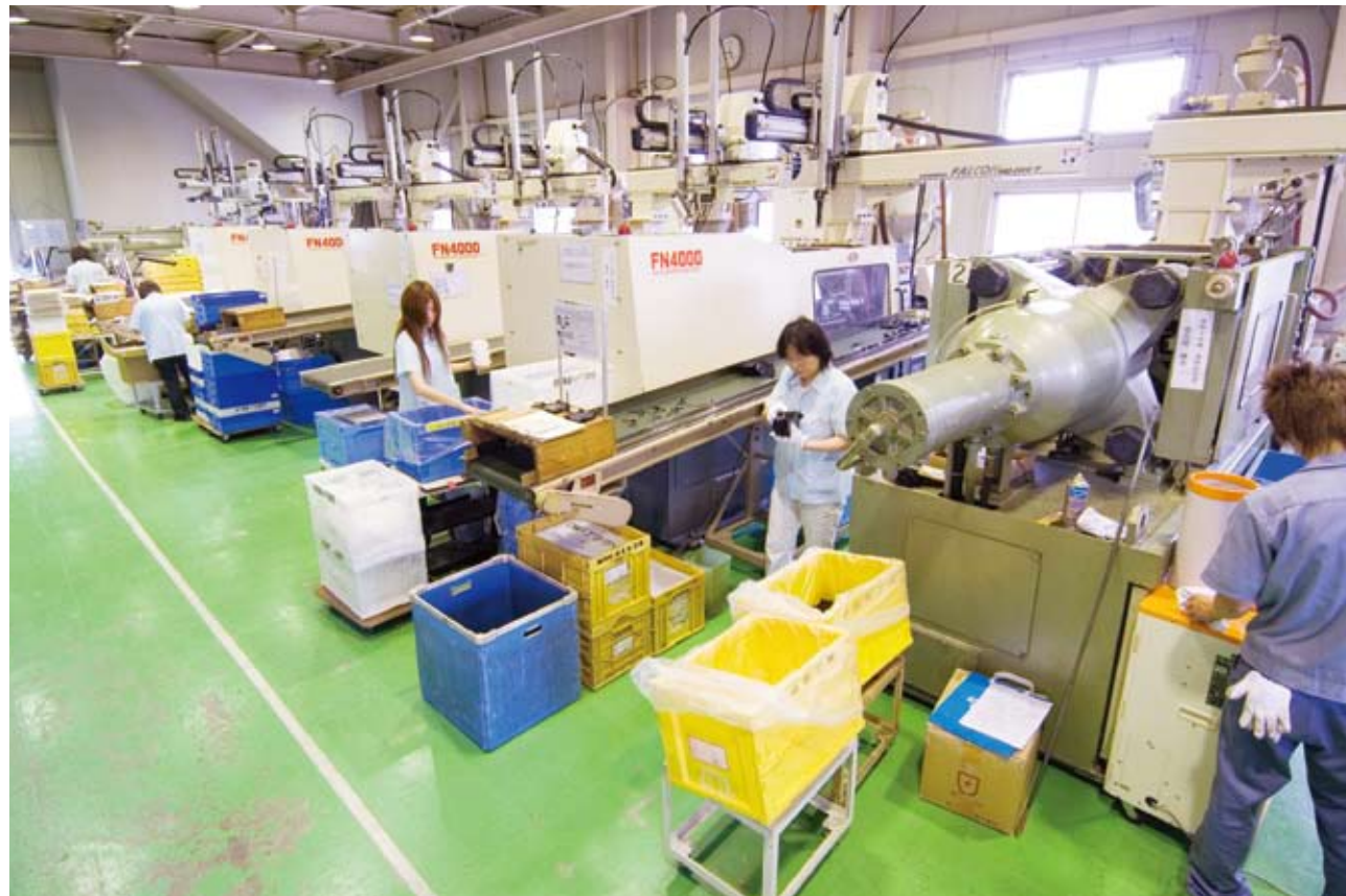
福島工場の成形ライン 60～360tの成形機が立ち並ぶ
