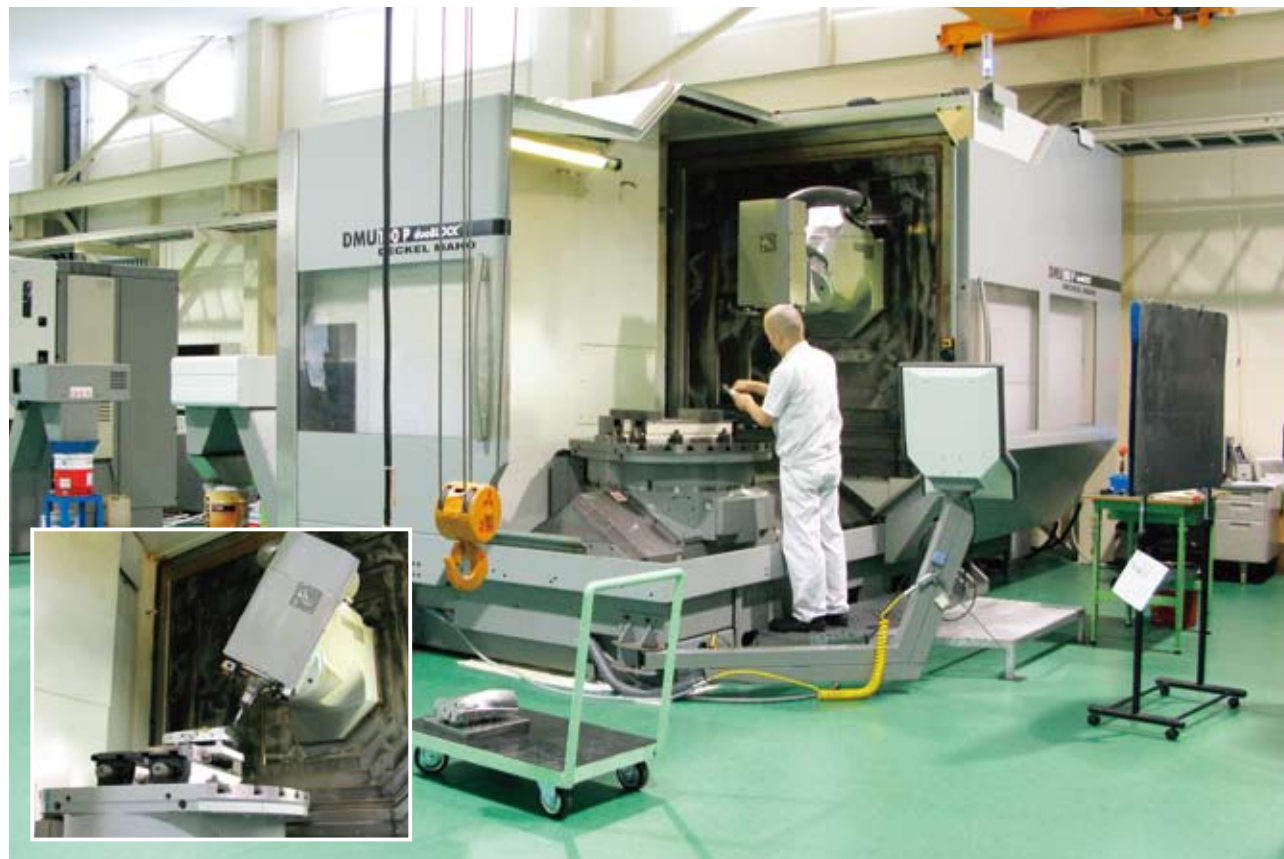
DMU社製の同時5軸加工機（3台）
