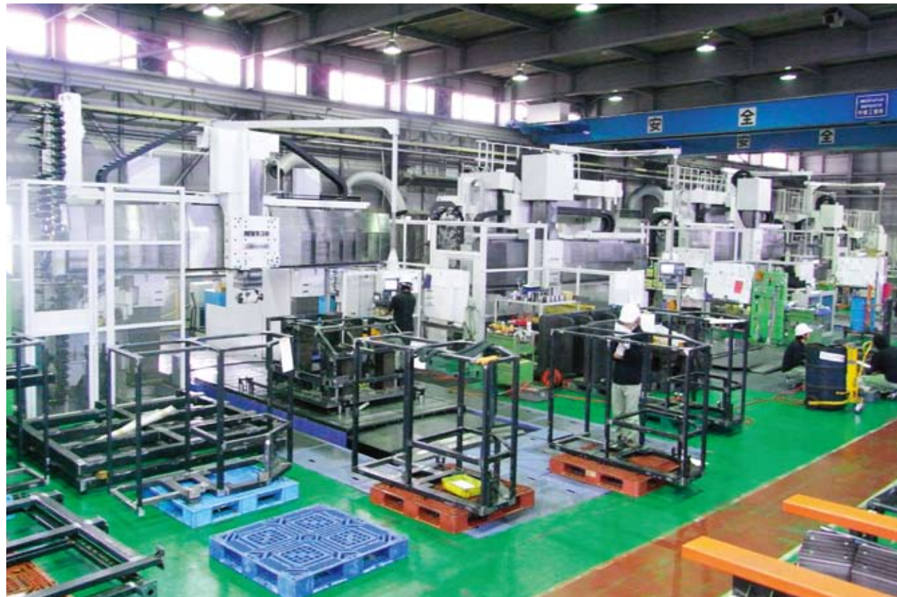
南工場に設備された5台の五軸門型マシンニングセンタ
