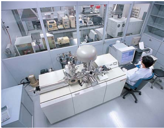
光電子分光装置XPSにて、物質の表面状態を測定。
