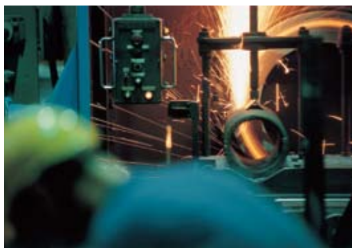
研磨作業で座面を仕上げる。
