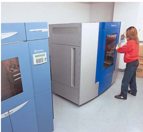
二台並んだ造形機。最大で600×500×600の造形を行うことが出来る。
