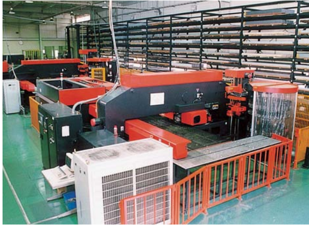
茨木工場の自動ライン。24時間回うが出来るのも地方工場の強みだ。
