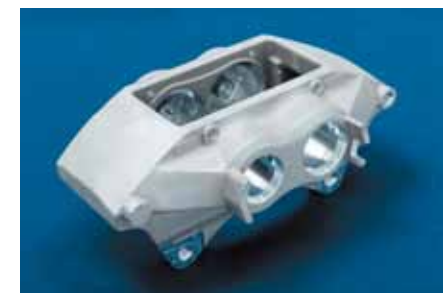
スポーツタイプ高性能一体型キャリバー。製品の中にアルミパイプが鑄包まれている。
