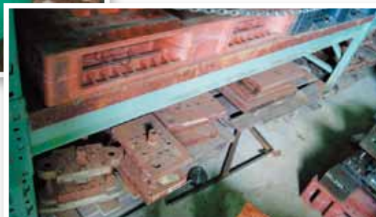
金型の接合部の穴にはびっしりと泥が詰まり、洗浄は困難を極めた。
