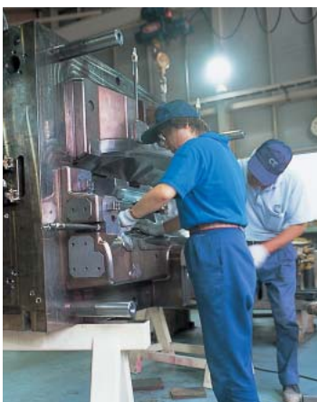
大きな金型を二人がかりで懸命に磨き上げる。
