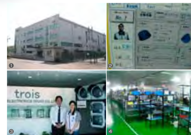
① 国内・中国での大小ロットの生産が可能な TROIS ELECTRONICS (WUXI) CO.,LTD. (=大日光・エンジニアリング無錫工場)。近隣に日本と全く遜色のない精密部品メーカーが多数（射出成形、プレス）。② スタッフの改善提案シート、毎月「Best Idea」と「Money Down」でそれぞれNo.1を表彰している。③ 信号機の製造 TROIS (WUXI) の営業窓口の常泉さん（左）と胡虹さん（右）。さわやかな対応が印象的。④ クリーンルーム（クラス5000レベル）内での組立現場（検査工程）。
