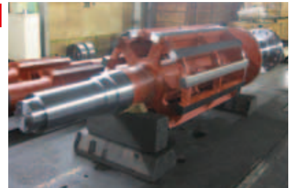
高精度圧延ワークロール 客先の仕様に応じた表面粗さ、振れ精度をミクロン単位で加工
