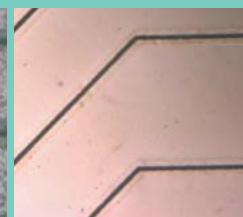
巾10μm高さ10μmのラインを形成した微細金型
