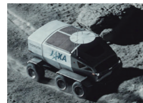
国立研究開発法人宇宙航空研究開発機構(JAXA)およびトヨタ自動車株式会社の共同研究による、燃料電池車両技術を用いた月面でのモビリティ「有人月面探査モビリティ」(愛称: LUNAR CRUISER(ルナクルーザー))
