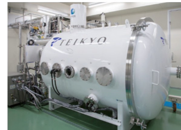
打ち上げ後の衛星の信頼性向上に必要な不可欠なスペースチャンバー
