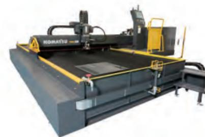
TWCL: 水中ファイバーレーザー切断機
