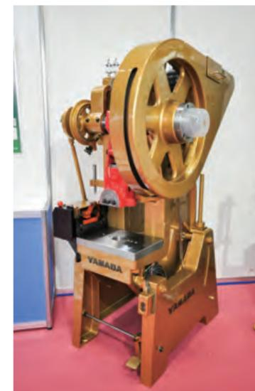
1961年に開発された国産第1号機の高速プレス機20R(C型20トンプレス機)
