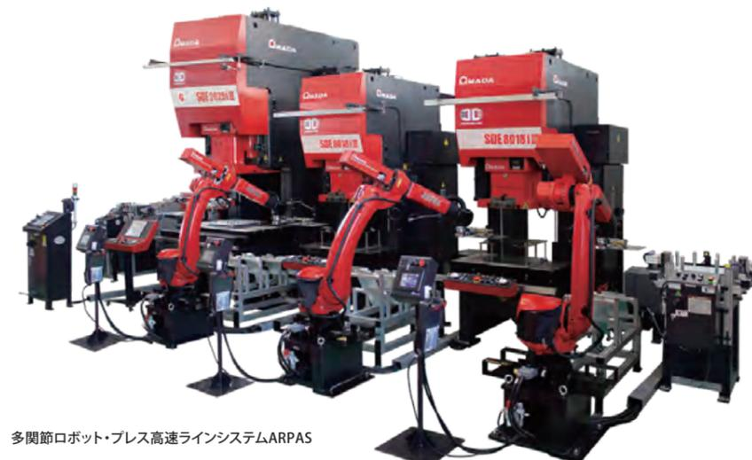
多関節ロボット・プレス高速ラインシステムARPAS
