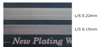
3D-MID製品へのめっき配線加工
