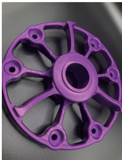
着色（紫）アルマイト処理（材質：アルミ）の事例
