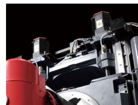
DCG™（重心駆動） 2本のボールねじで構造物の重心を押し、 振動を抑制させ高速・高精度加工を実現します。
