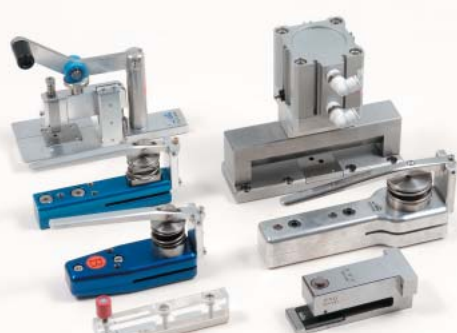
精密研磨技術で製作される治具、スプライサー等
