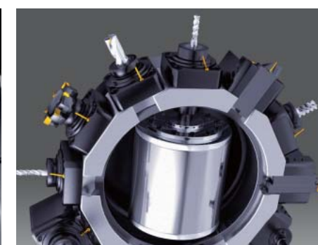
ビルトインモータ・タレット 発熱や振動を最小限に抑制するとともに伝達効率を 向上し、加工精度と切削力を大幅に高めます。
