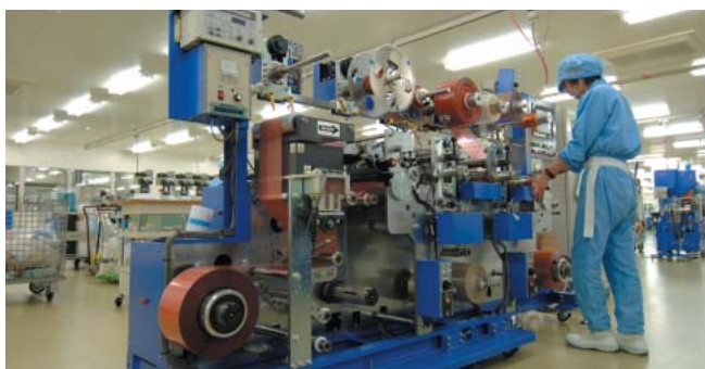
7月に新本社工場が始動した。広いクリーンルーム（クラス8）では製品の用途に合わせたラミネートや検品作業などが行われている
