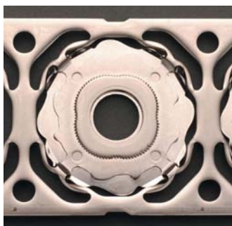
非円形歯車、内径のリブ、裏面のダボなど複雑形状が集約されている。
