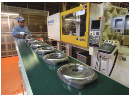
プレス加工に、インサート成形を加え設計者の望みに対応。
