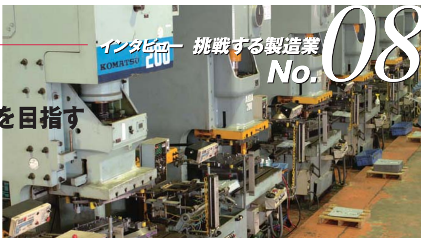
トランスファーでは困難だった加工を可能にした、11台に及ぶ大型プレスライン。
