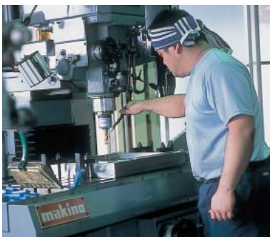
職人の確かな腕により、プラモデルの命になる金型がつくられる。
