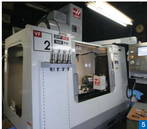
1／代表取締役社長 宮井 康忠氏 2／得意とするステンレス加工品の数々 3／3代目の長女 佐智子さん 4／利便性の高いNC装置 5／VF-2立型マシニングセンター
