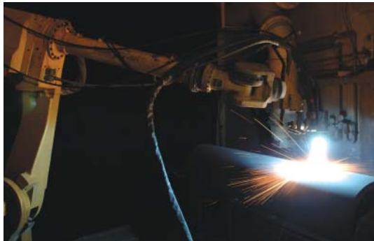
ロボットにより自動化された溶射設備。
