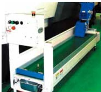
製品満杯検知で箱を自動交換する。
