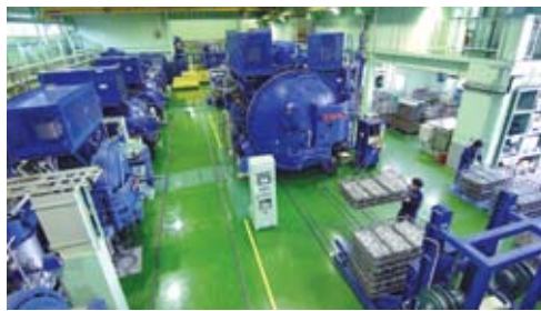
20機（1日35tの処理能力）の真空熱処理炉を持つ最新鋭工場。
