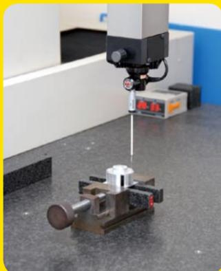
1ミクロン(1000分の1mm)の精度が保証された3次元測定器。品質管理の要である
