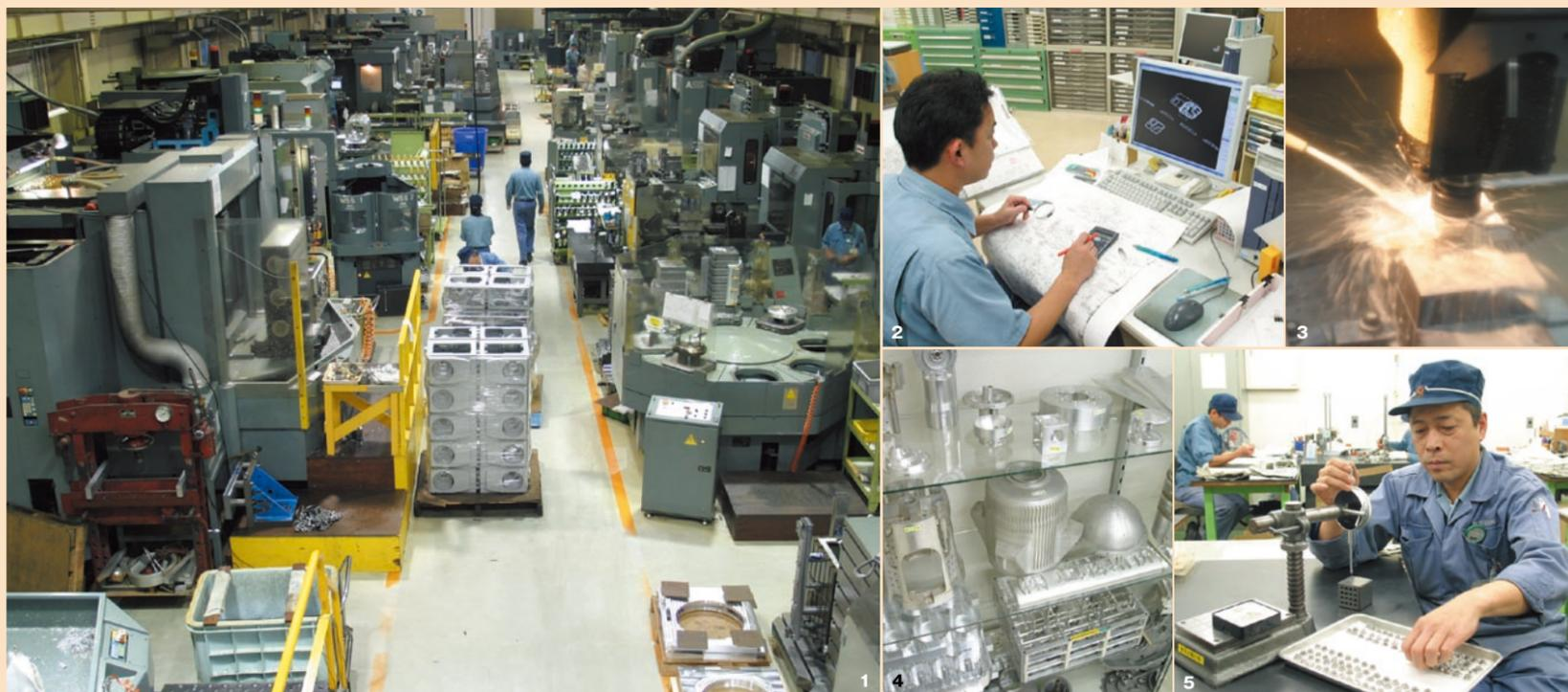
1.24時間稼働する広大な工場(東京都羽村市) 2.図面データからCAD/CAM、機械入力までをネットワーク化 3.マシニングセンターによる複雑な切削加工 4.塩野製作所の技術力を示す部品の数々 5.精密部品は機械設備だけでは完成しない
