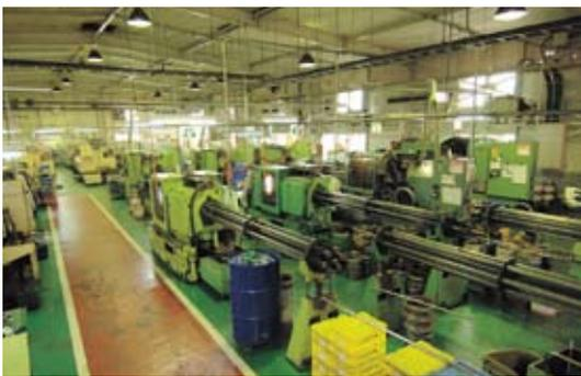
NC旋盤、6軸自動旋盤など多数保有。
