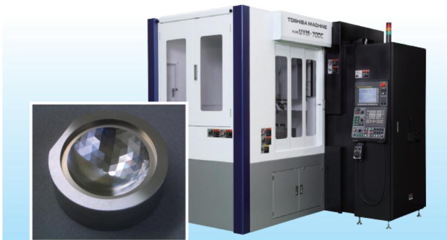
コストパフォーマンスに優れた高速・高精度加工機 UVMシリーズに、長ストローク仕様の700Cが新登場！ 自社製高精度・高速空気静圧軸受主軸に加え、世界最高性能を誇る当社製レンズ金型加工機で実績を誇る高分解能リニアモータ制御、加工精度の安定化を実現する構造体冷却システムなど、当社独自の技術を標準搭載したコストパフォーマンスに優れた高精度加工機である。今回、テーブル作業面を従来の□450mmから□700mmに拡張し、従来機で実現した1ランク上の超高速・超高品位加工を、大物ワークに対しても可能にした。また展示機は5軸加工機にも拡張可能。会場では、自動車ヘッドランプ光源のLED化に伴い、高品位加工が要求される自動車用クリアランスランプ金型の加工実演を行う。
