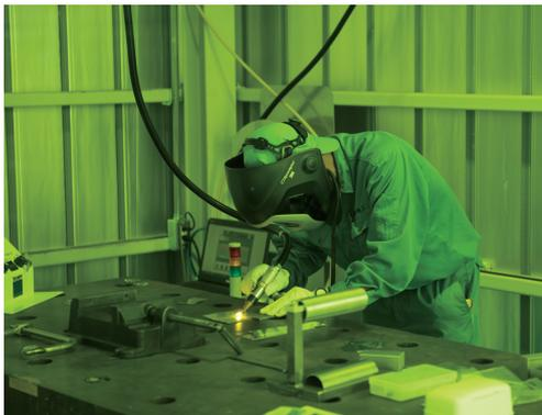
2013年に導入したYAGレーザー溶接機
