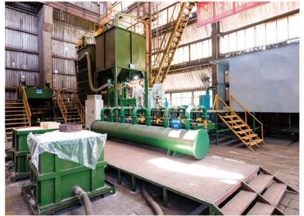
Dây chuyền đúc mẫu chảy. Công suất: 2.800 tấn/năm
