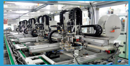
部品検査機 (概観検査、寸法測定等...)
