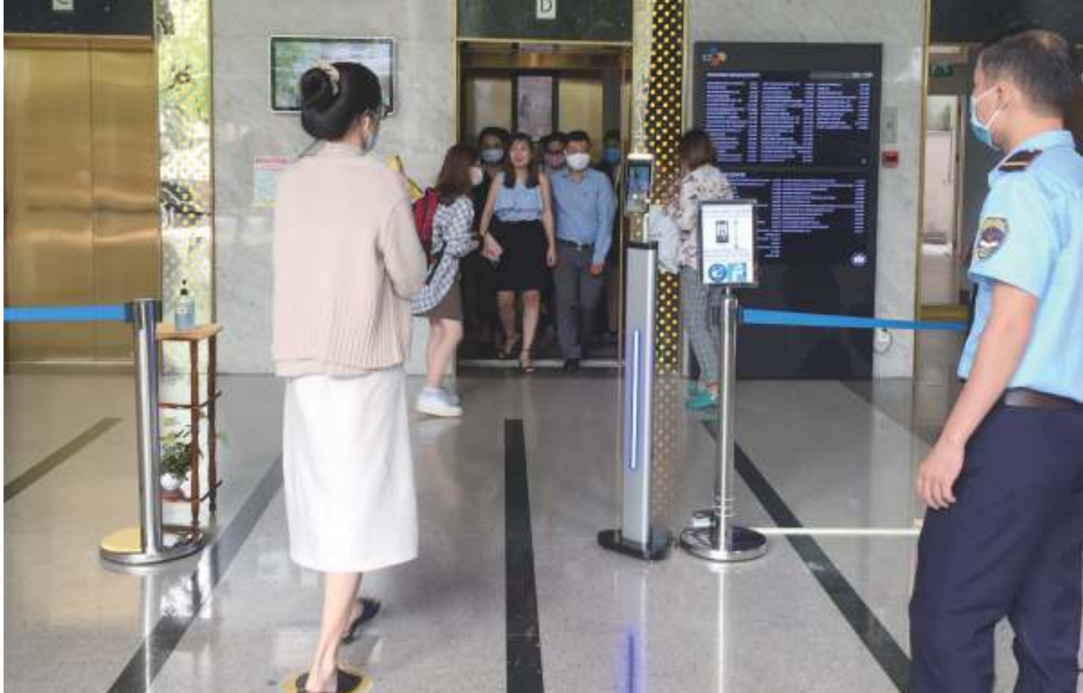
オフィスビルの入り口に設置されたリモート体温計測器（真ん中付近のディスプレイ）
