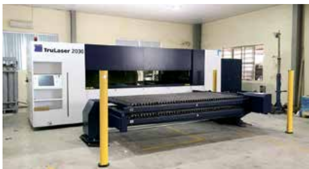
Máy gia công laser TruLaser 2030 (Trumpf) mà công ty LGMEC đang sử dụng
