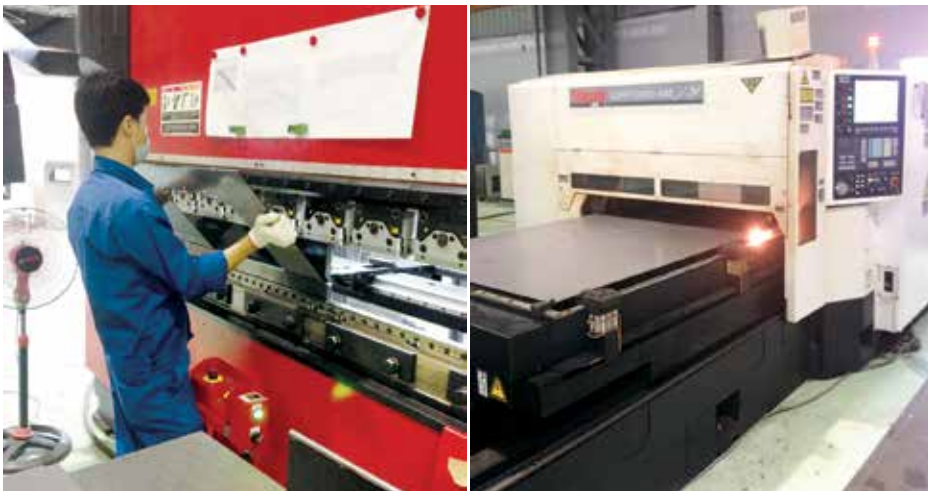
Gia công chấn và máy gia công laser (Mazak) tại công ty Yoshimura Kogyo
