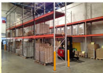
重量ラック(通路幅3M)
