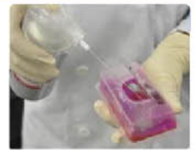
① 検査する部分にスプレー / ② 漏れを確認する部分に塗る
