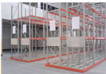
重量ラック(通路幅1.5M)
