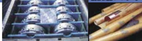
油を使わないので洗浄工程なしですぐに組み立て工程に進めます。
