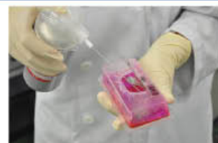
① 検査する部分にスプレー / ② 漏れ部分に赤い染料が滲み出る
