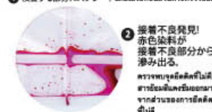
① 検査する部分にスプレー / ② 漏れ部分に赤い染料が滲み出る
