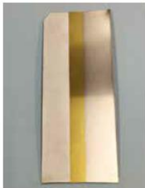
Cu下地半光沢Snストライプめっき / Ni下地光沢Agストライプめっき (C2680材)
