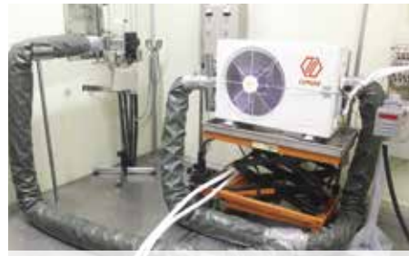
自然冷媒の循環システムを展示
