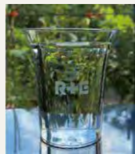
図4 世界最薄肉(0.53mm)ポリ乳酸射出成形カップ「R+E®」:株式会社三義漆器店。CO 2 超臨界射出成形法で多数個取り成形。©Yuki Komatsu,2023,Japan
