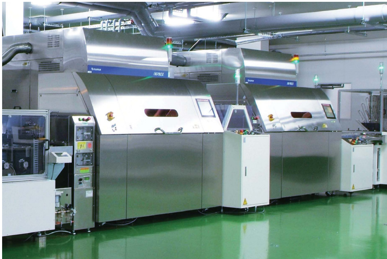
いち早くレーザーによる直接描画システムを導入し、短納期化を実現
