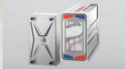
水を電気分解して水素と酸素を発生させる科学反応を理科の実験で経験しただろうか? 燃料電池の原理は、水の電気分解の逆、つまり、水素と酸素を反応させて電気と水を発生させる。FCXクラリティは、燃料電池で電気を発生。その電気でモーターを回して走行する。電気エネルギーの発生時に水しか排出しないのである。
