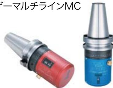
大型機械のワーク位置決め、レーザー照射によるマーキングで作業が簡単スピーディーに！ マシニングセンタ用ワーク位置決め装置のレーザーマルチラインMCは、垂直と水平ラインの同時照射(十字)やレーザー照射方向の調整が可能。また、パルス光に切り替え、レーザーシーバー(別売)を使えば、明るい場所でも使用できる。
