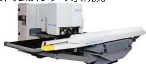
村田機械は、サーボモータ式タレットパンチプレス「モトラムUTシリーズ」を開発した。本シリーズは、軽量高剛性化された新プレスドライブ機構の採用により、成形加工後やワークホルダー近傍加工時の金型上下退避動作が速くなり、実加工時のサイクルタイムを短縮。さらにパンチ加工時に発生される振動を従来機比で約30%低減している。
