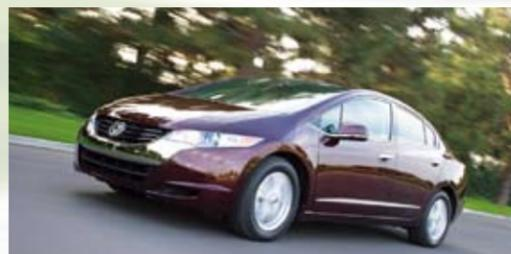
FCXクラリティでは、Honda V Flow FCスタック(燃料電池ユニット)が高出力とリチウムイオンバッテリーによるパワーアシストによって、新開発の高出力モーターを駆動させる。従来のガソリン自動車にはなかった加速感、アクセルのレスポンス感を実現している。
