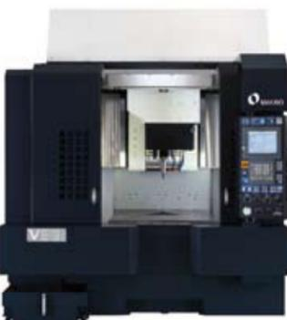
牧野フライス製作所はインテリジェント機能を搭載した立形マシニングセンタV56iの販売を開始した。同機能では機械姿勢変形による主軸先端位置のズレを数ミクロンに抑えることで、長時間の加工において安定した精度を維持することができ、一般的な工場環境下で高生産性と高精度を両立させることを可能とした。
