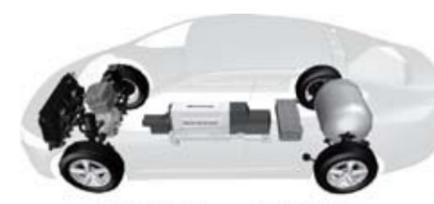
(注2) FCXクラリティは、「Vフロア」によって低床の革新的なデザインを実現した。これは「燃料電池を縦にすれば発電効率が向上しそう」という技術者の発想と、「床をもっと下げたい」と言うデザイン面からの要望が偶然にも合致したものだ。燃料電池を縦にすると技術的革新によって小型化を達成することができ、これまで床下に収納するしかなかった燃料電池を丸のようにコンパクトに収めることが出来た。課題解決のため必然的に生まれた策が、偶然にもデザイン面の要望にも合致していたためFCXクラリティの形状が実現したのだ。
