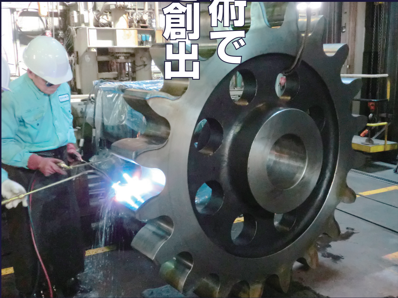
同社の熱処理技術において飛躍のきっかけとなった炎焼入れ技術
